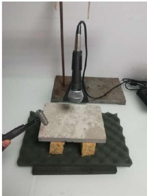
*Figure 39 dispositif d'acquisition sonore sur éprouvette plaque*
